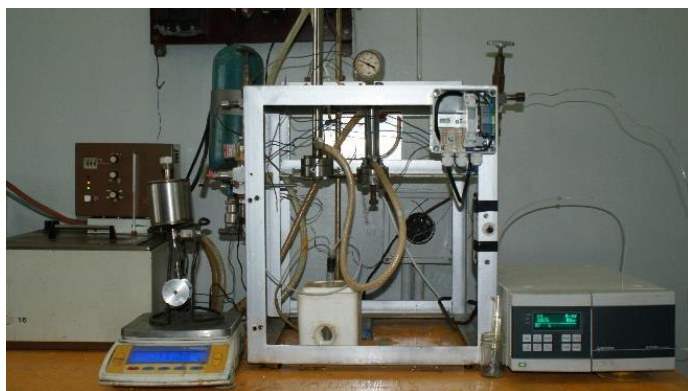
Рис. 2. Лабораторна установка епоксидування пропілену перексидом водню.
