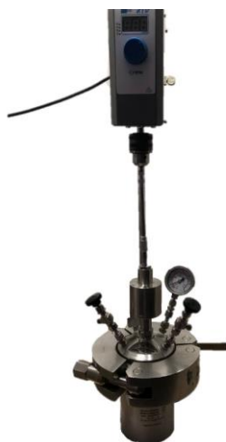
Рис. 1. Автоклавний реактор (RVD-3-700), виробництва ТОВ «НВП Укроргсинтез»
