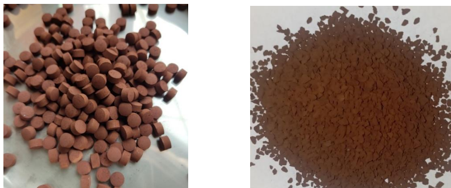
Рис. 1. Таблетований та подрібнений (фракція 2-3 мм) С3 каталізатор
