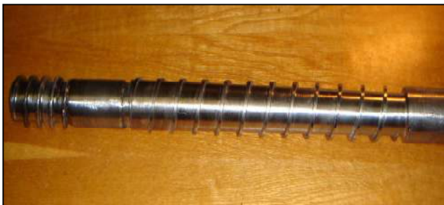
Рис. 2. Робочий орган одношнекового екструдера з “торпедою”: діаметр – 45 мм, кількість витків – 12, крок – 32 мм і глибина нарізки – 4,5 мм (вхід), 1,5 мм (вихід)
