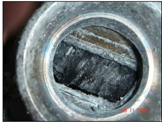
Рис.3 Налипання компонентів композиції КРА на робочий орган одношнекового екструдера під час отримання КРА
