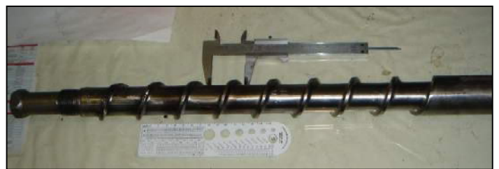
Рис. 4. Шнек без “торпеди”: діаметр – 45 мм, крок – 45 мм, вісім витків з глибиною нарізки на вході 6,5 мм, на виході – 5,0 мм
