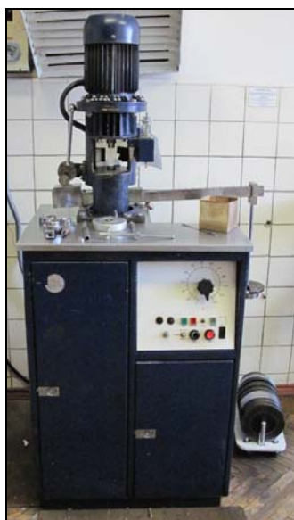
Рис. 2. Чотирикулькова машина тертя ЧМТ-1 (а) та її робочий вузол тертя (б): 1 – верхня кулька; 2 – патрон; 3 – шпindelь; 4 – шпилька; 5 – три нижні кульки; 6 – гайка; 7 – шайба; 8 – чашка; 9 – диск; 10 – упорний підшипник; 11 – втулка; 12 – бронзова прокладка; 13 – гумова прокладка; 14 – ножова опора; 15 – важіль змінних ваг
